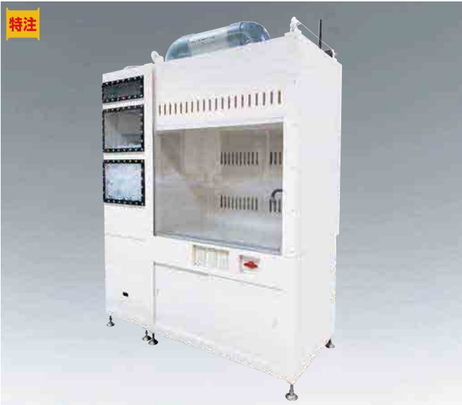
スクラパー付エッチングチャンバー (W1700×D850×H2150mm)
